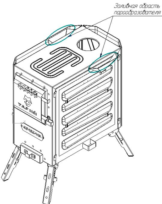
Рисунок 10 Расположение воронок парообразователя
