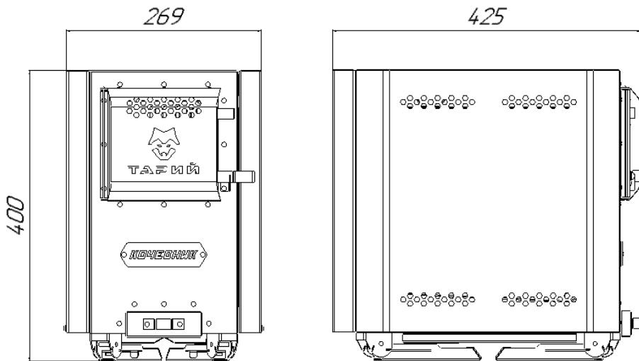
Рисунок 4 Печь в сложенном (транспортировочном) состоянии
